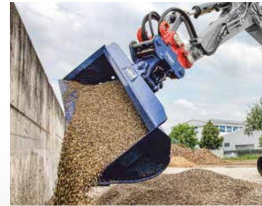
Adaptateur Symlock® pour transformer par ex. les godets de curage en godet à basculement latéral
