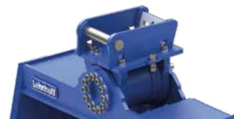
par ex. moteur de rotation hydraulique sur godet hydro-universel
