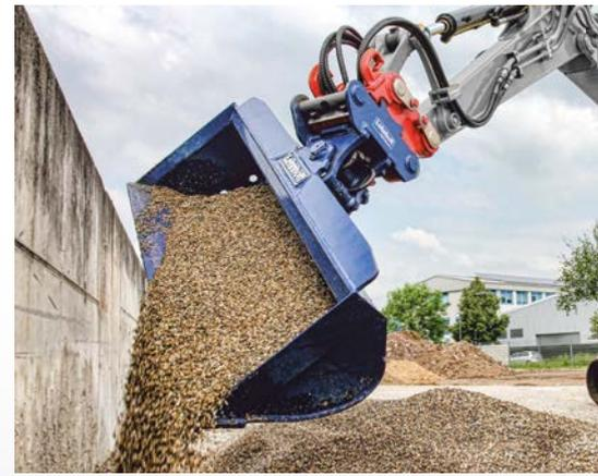
Symlock-Adapter macht z. B. aus Grabenräumlöffeln eine Seitenkippschaufel
