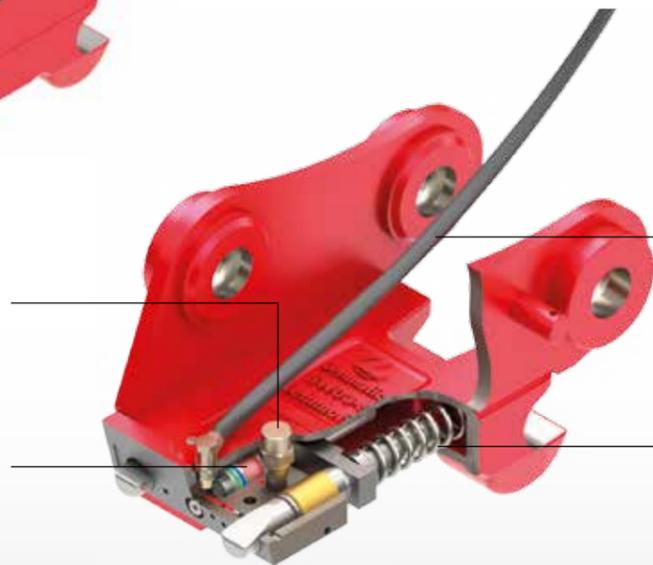
Une seule conduite hydraulique suffit pour l'installation
