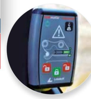
Lehmatic Safety Control LSC, en option pour tous les systèmes d'attaches rapides hydrauliques Lehnhoff
