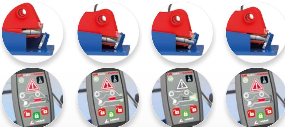
Attache rapide déverrouillée, pas encore complètement introduite dans l'adaptateur
