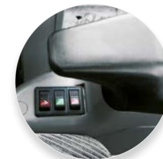
Le bouton-poussoir déverrouillable pour l'actionnement sert de dispositif de protection contre tout déverrouillage involontaire. Contrôle du verrouillage par l'intermédiaire d'une cheville-témoin au niveau de l'attache rapide.
