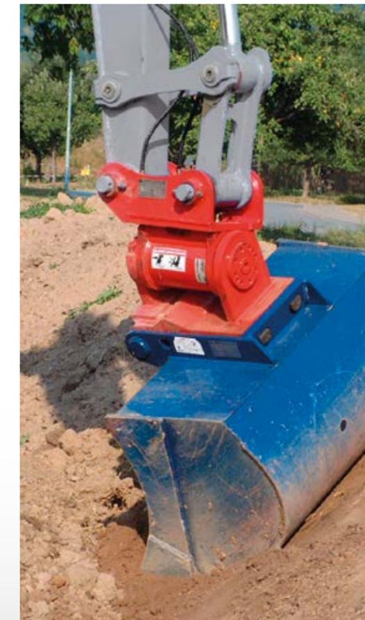
Rotator avec couplage d'attache rapide côté pelle (sandwich)
