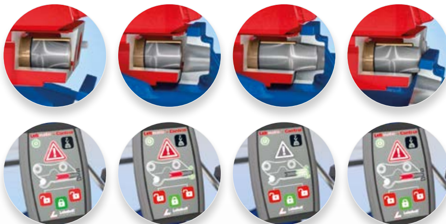
Attache rapide déverrouillée, pas encore complètement introduite dans l'adaptateur
