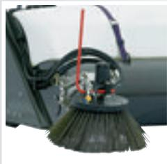
Seitenbürste, mechanisches Anheben/Absenken.
