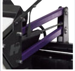
Druckausgleich – ein einzigartiges Konzept, bei dem die Kehrwalze auch bei unebenen Bodenverhältnissen immer den optimalen Bodenkontakt hat, hierdurch werden Stützräder überflüssig.
