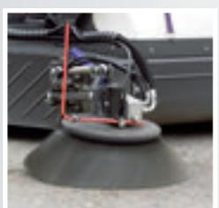
Seitenbürste, hydraulisches Anheben/Absenken. Wird von der Kabine aus gesteuert.
