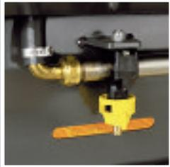
Bewässerungswasser wird zum Staubbinden und für sparsameren Wasserverbrauch von hinten in die Kehrwalze eingesprüht.
