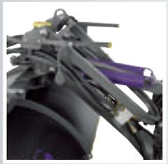
Druckausgleich – ein einzigartiges Konzept, bei dem die Kehrwalze auch bei unebenen Bodenverhältnissen immer den gleichen Bodenkontakt hat, hierdurch werden Stützräder überflüssig.
