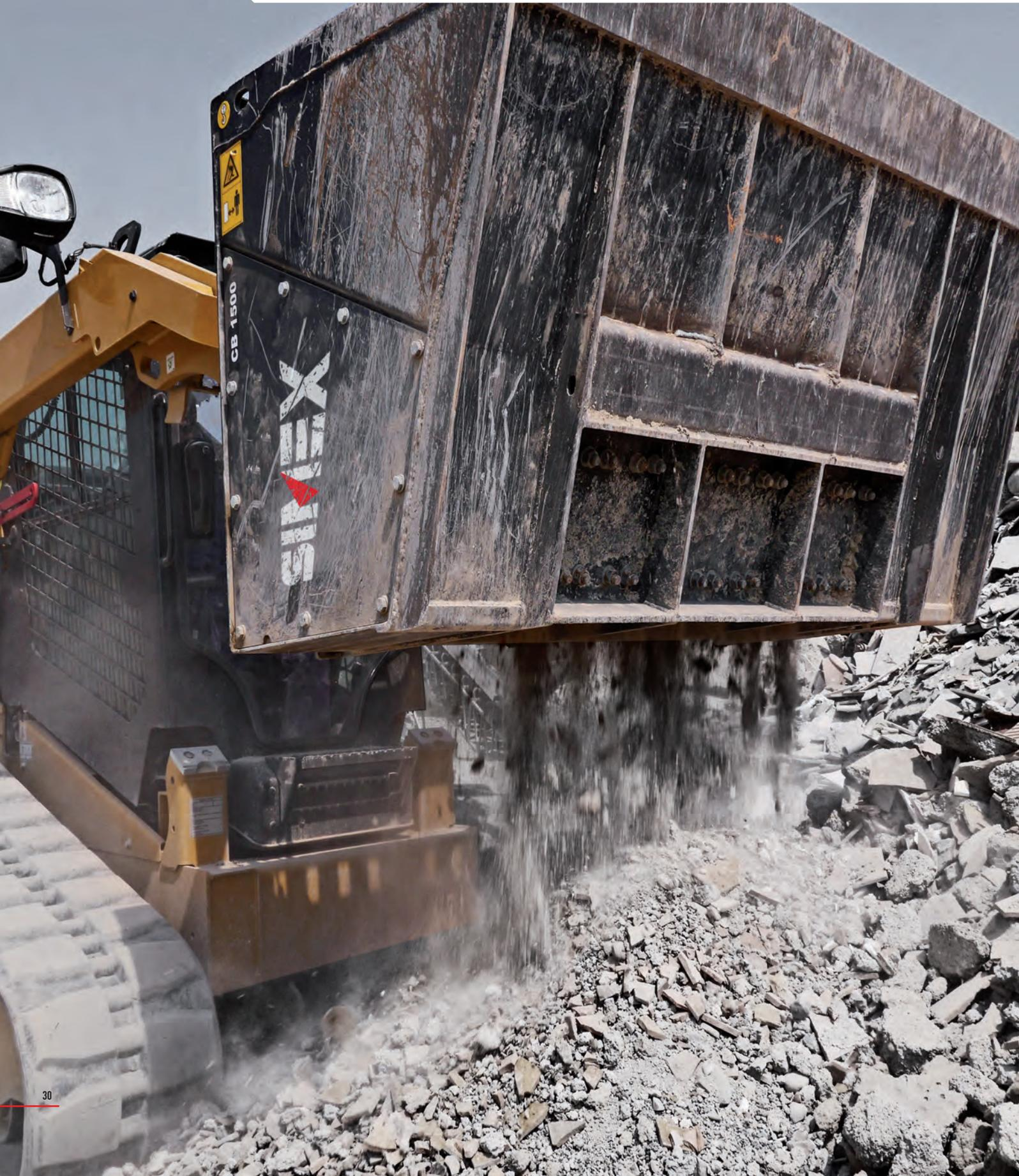
■ Conçus pour la réduction de la granulométrie des matériaux inertes.
