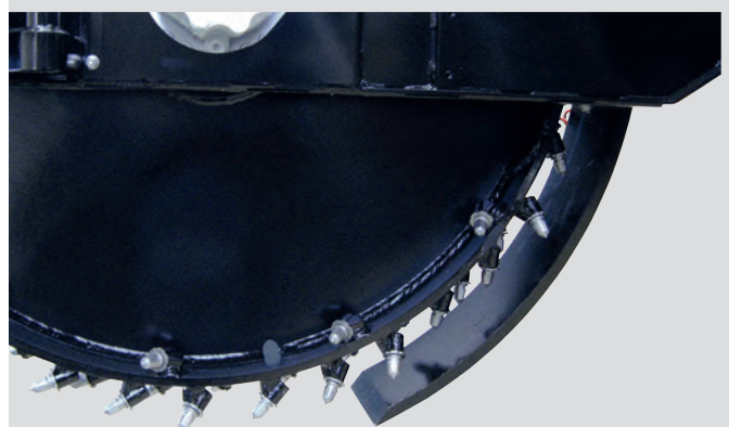
Vorrichtung zur Entleerung des Grabens
