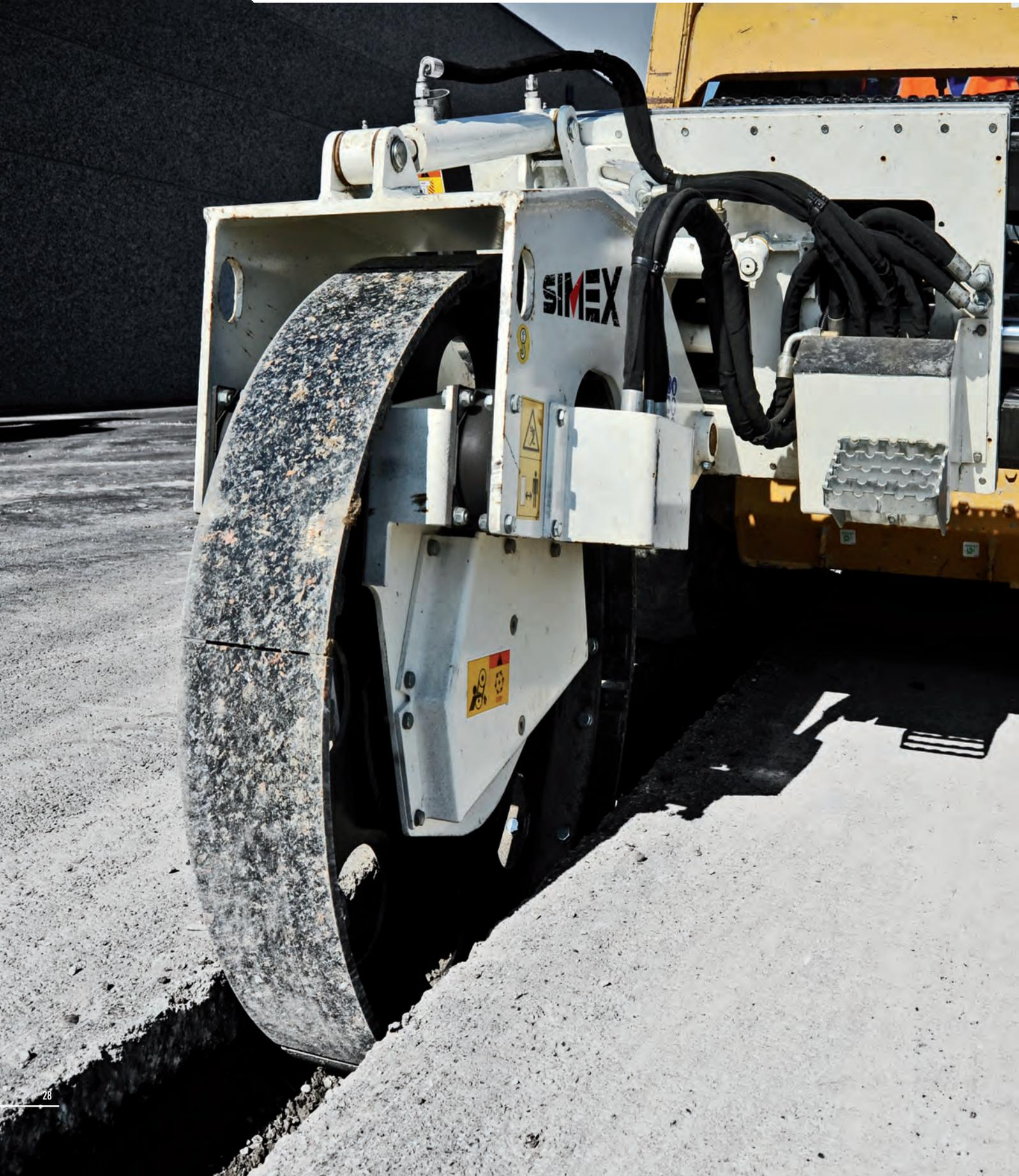
■ **Entwickelt zum Verdichten von Füllungen in Gräben**
